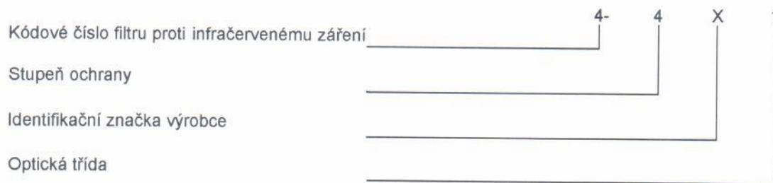
f) Filtry proti infračervenému záření s mechanickou odolností, s odolností proti přilnutí roztaveného kovu a proniknutí horkých pevných částic
