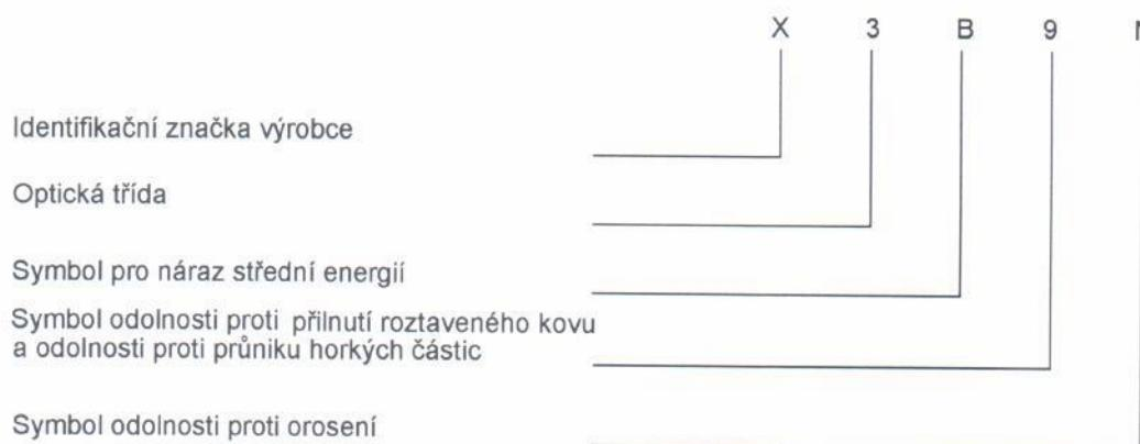
m) Filtr proti ultrafialovému záření s mechanickou odolností, odolností proti poškození povrchu jemnými částicemi a odolností proti orosení
