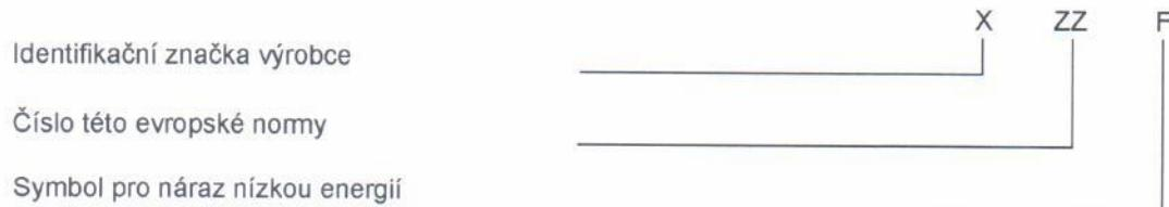
Místo symbolu F ve výše uvedeném příkladě lze použít symbol B ke značení obruby nebo nosné části štítu užívané k ochraně proti částicím s vysokou rychlostí o střední energii nárazu a symbol A ke značení obruby užívané pro ochranu proti částicím s vysokou rychlostí o vysoké energii nárazu. Pokud je obruba nebo nosná část štítu určena proti částicím vysokou rychlostí při extrémních teplotách, doplňují se symboly písmenem T tj. FT, BT nebo AT.
