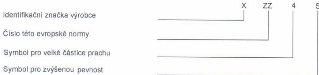
Místo symbolů 3 a 4 v uvedených příkladech by měly být použity symboly 5, 8 a 9 ke značení obrub nebo nosných částí štítu chránících proti plynům a jemnému prachu (5), elektrickému oblouku vzniklého z krátkého spojení (8) a roztavenému kovu a horkým pevným částicím (9).
